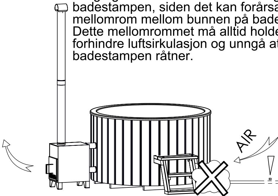
Det er lett å installere en badestamp selv, siden du får den i ferdigmontert stand. Bare juster den utvendige ovnen med gummislangene og installer et rør. For å justere slangene på ovnen, trekker du dem tett inn på ovnflensene, så slangene dekker flensene i rundt 4 cm. For å gi tettere passform kan du såpe inn slangene fra innsiden. Når slangene er ordentlig plassert, fester du dem med klemmer.
