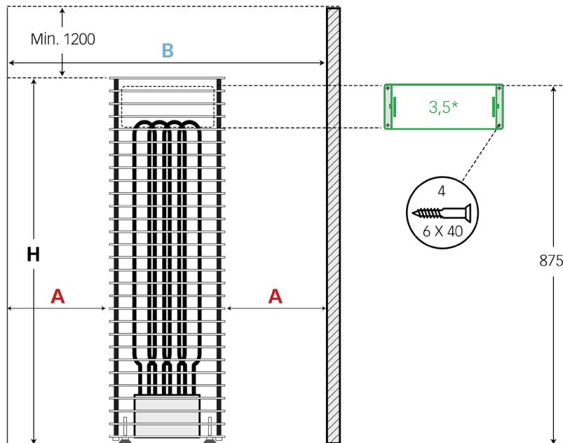
\* CLIFF 3,5 wird mit einem speziellen Winkelstück an die Wand befestigt
