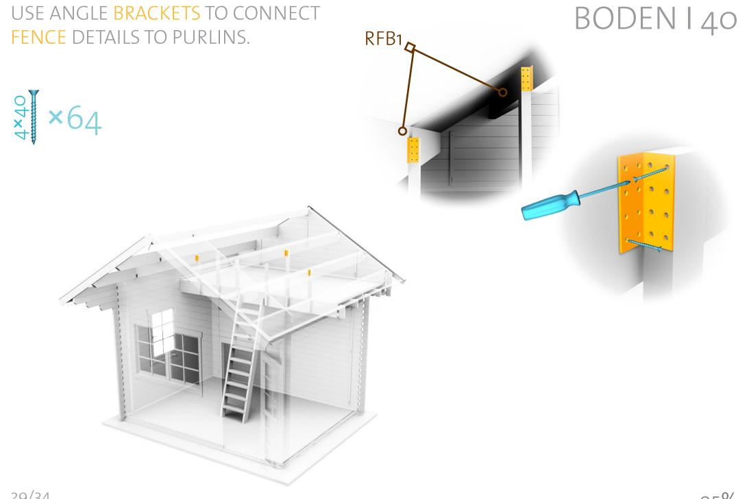
SAW THE FENCE DETAILS INTO RIGHT LENGTH DEPENDING ON WHERE YOU POSITIONED
